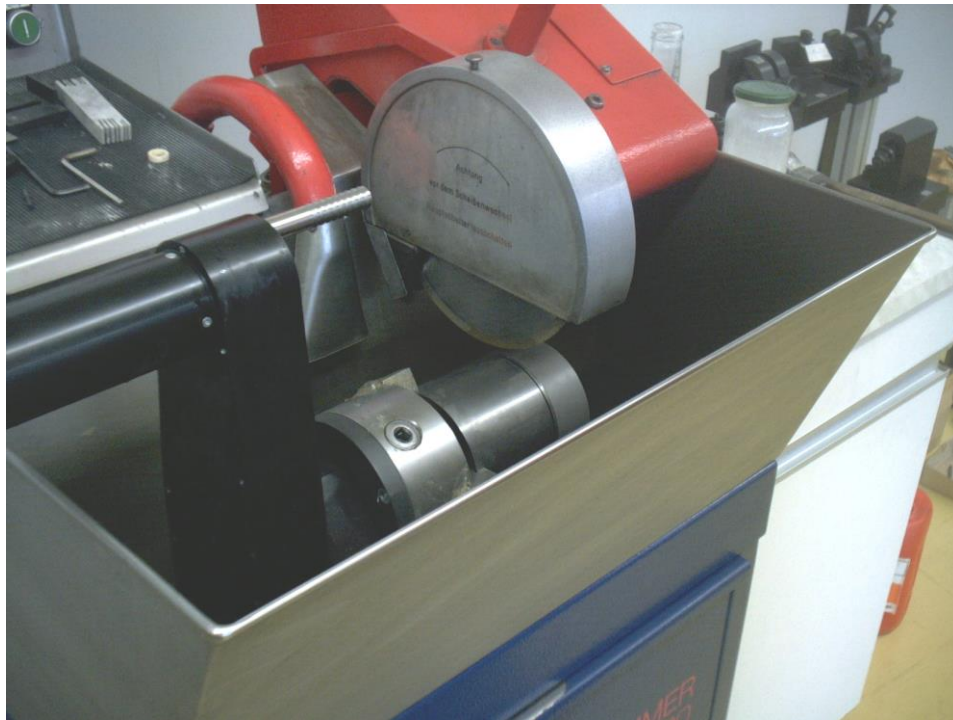
Drehvorrichtung 370.17.200.00 für große Werkstücke bis D_{\max.} = 125 \text{ mm} Durchmesser. Antrieb des Dreibackenspannfutters über Elektromotor und Getriebe
