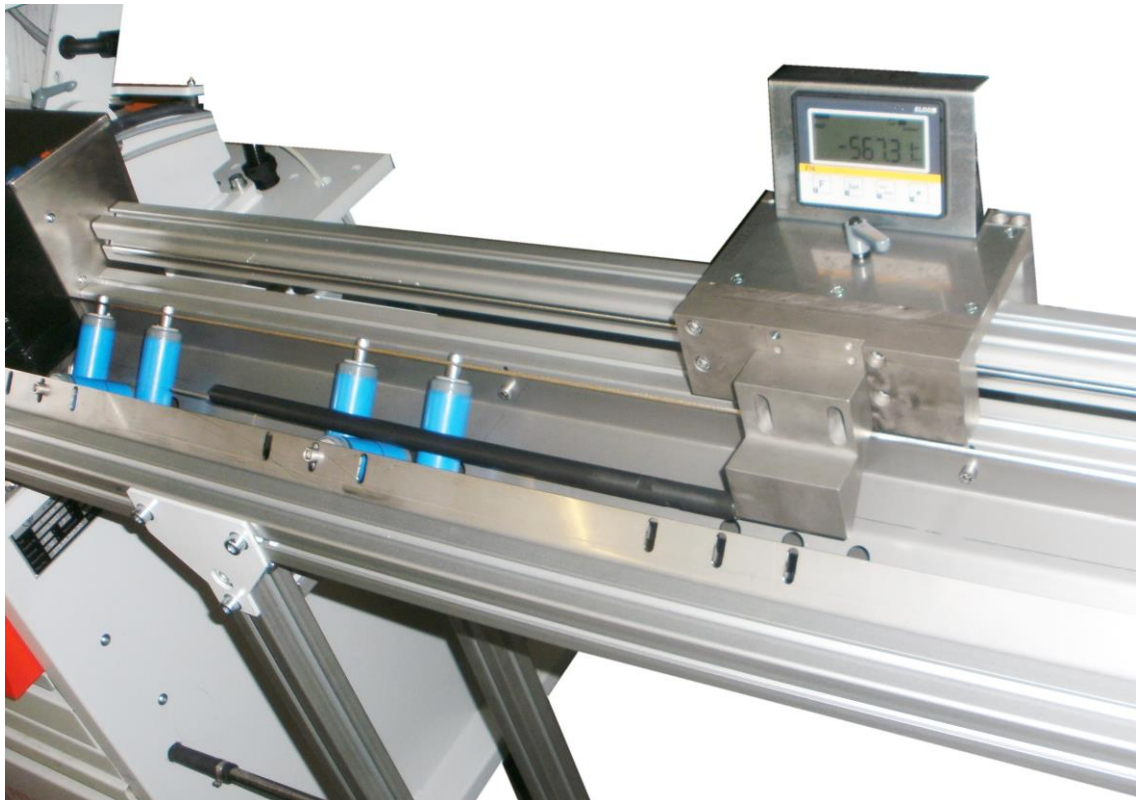
Messeinrichtung mit Digitalanzeige z.B. für 2m Messlänge 372.35.625.00
