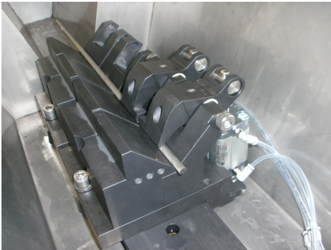
Pneumatische Spannvorrichtung mit V-Prisma 370.17.410.00
