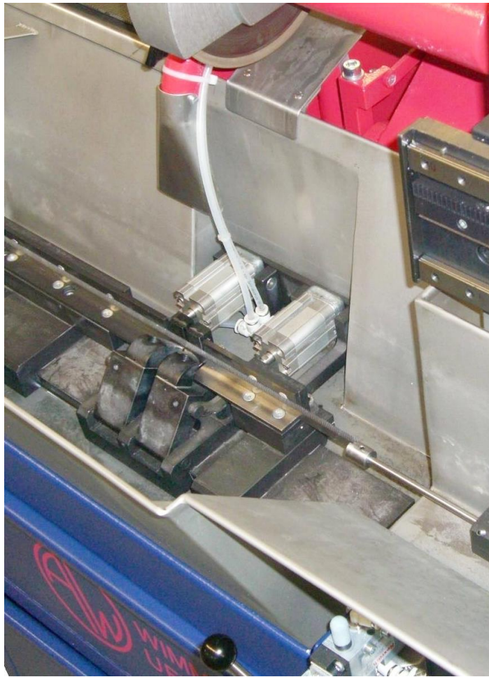
Pneumatische Spannvorrichtung mit 3-Punkt Klemmung 370.17.400.00
