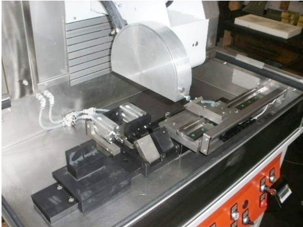
374.17.200.00 Pneumatische Drei-Punkt-Spannvorrichtung ohne HM mit eingebautem Messanschlag und Digitalanzeige 374.17.530.00
