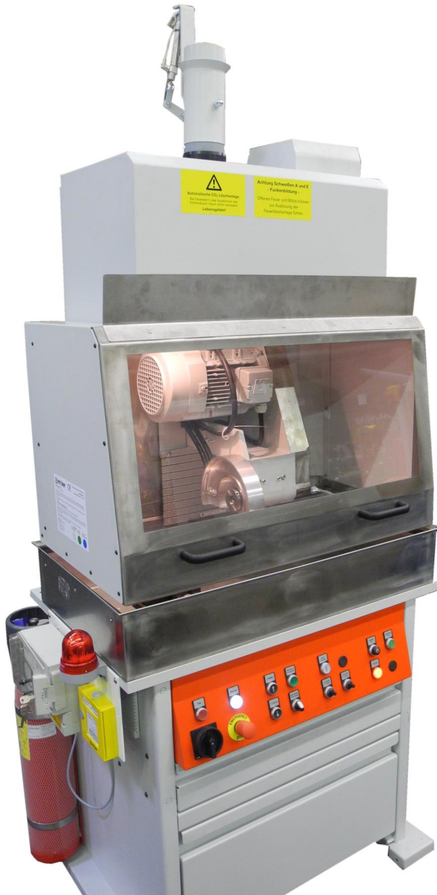
CO2 Löschanlage 374.90.200.00 mit Ölbetrieb
