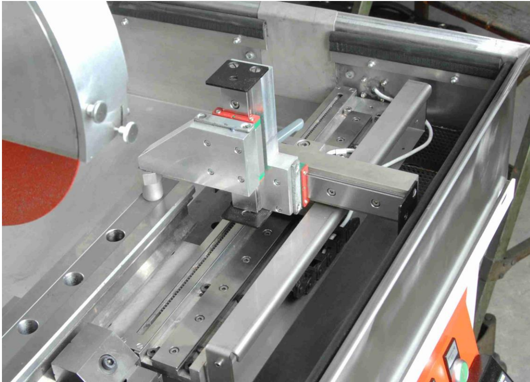
Absteckvorrichtung 374.17.540.00 zum Abstecken von Linearführungen
