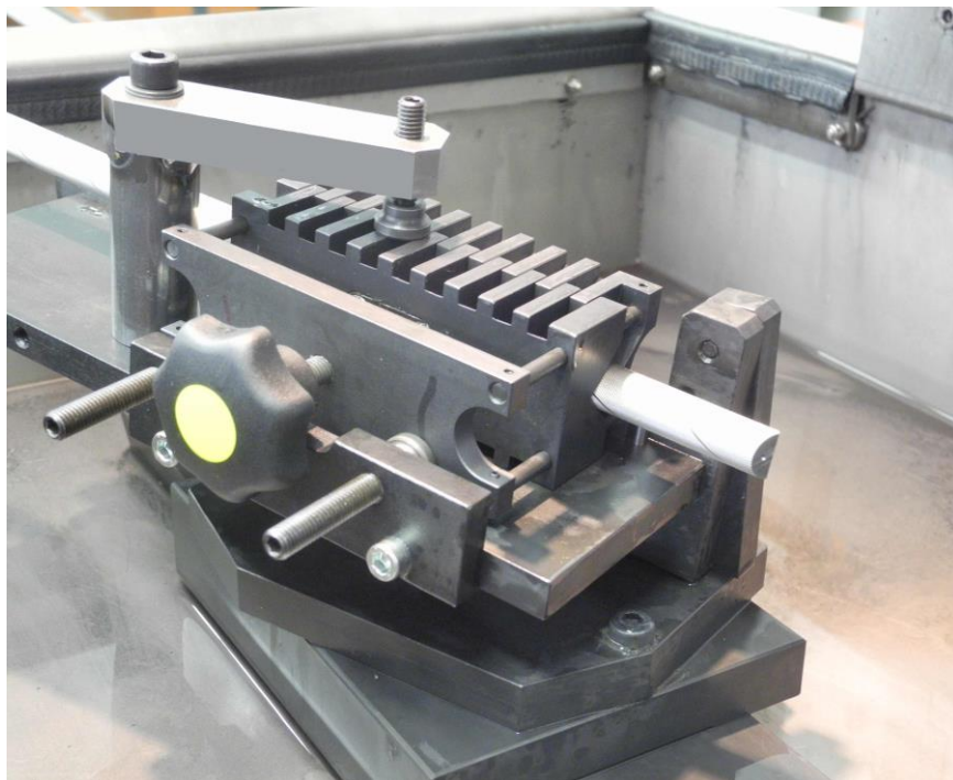
Bohrer-Spannvorrichtung 374.17.158.00 zum Trennen von kleinen Spiralbohrer bis \varnothing 25mm. Der Spitzenwinkel ist von 110^\circ bis 150^\circ einstellbar.
