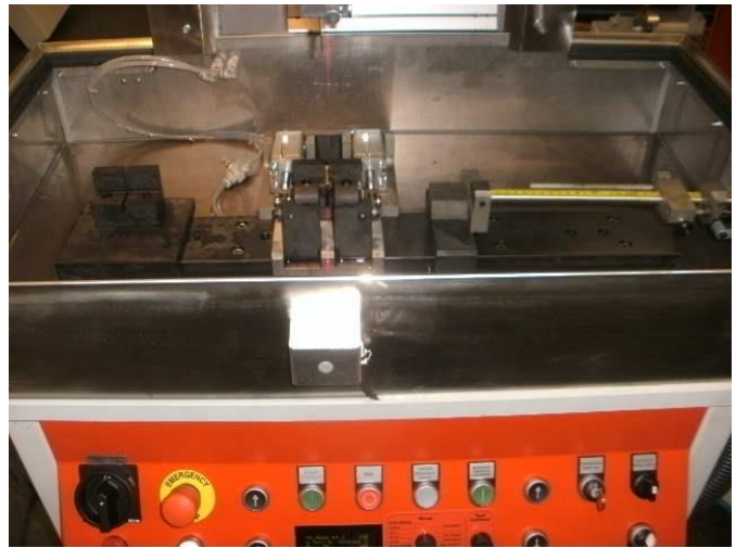
Linien-Laser 374.90.041.00 zum leichteren Einstellen verschiedener Spannvorrichtungen
