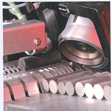
In kürzester Zeit umgerüstet, ist die Maschine bereit zum Schleifen von Vollspitzen.
