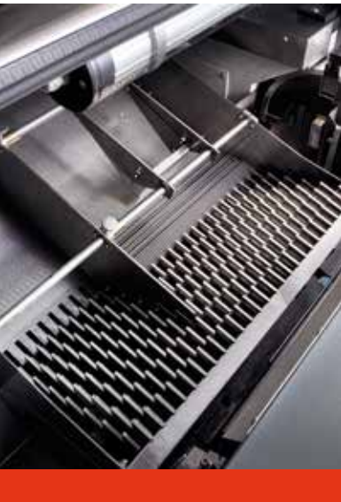
Hublader mit Vereinzeler für Großserienbetrieb
